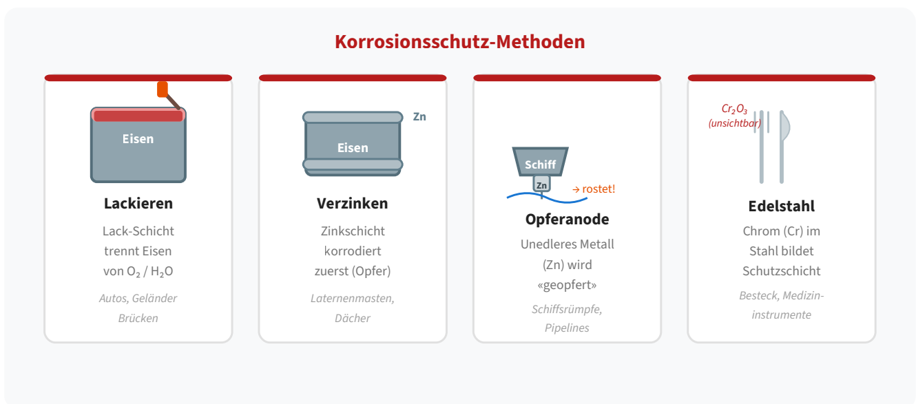
Abb. 4.2: Vier Methoden des Korrosionsschutzes im Überblick.
